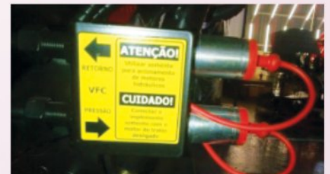
Detalhe do engate rápido da válvula de fluxo contínuo (VFC) que equipa os tratores. A posição do fluxo do óleo deve ser respeitada, obedecendo a indicação das setas
